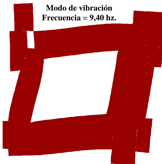
Figura 5.2. 155.- Modo de vibración U.E.N. Experimental Venezuela (Arreglo 1).
